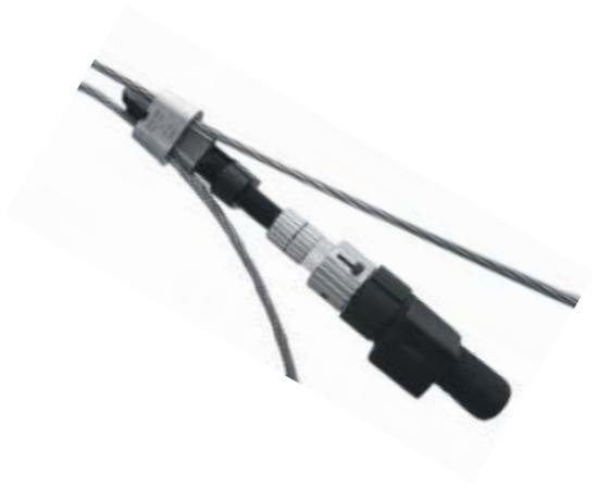
Los conectores de tipo ampact son aplicados a través de una herramienta específica, de fácil y rápido manejo, permitiendo al electricista, en situaciones críticas de emergencia, solución de conexión o extracción en mínimo tiempo, sin afectar los conductores que estén conectados. Se estima de 2 a 4 minutos más o menos el tiempo de conexión/extracción de los conectores tipo AMPACT, lo que los torna extremadamente prácticos y económicos.
